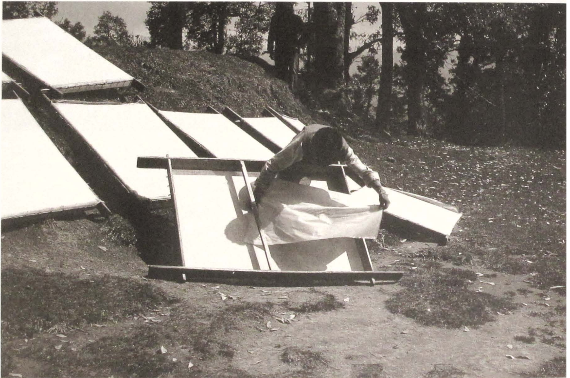
Oben: Papiererzeugung in den Städten wie hier am Ufer des Kyitschu in Lhasa war selten. Der Brei, aus dem das Papier gemacht wurde, bestand aus Stoffresten, Baumwolle und Seide.
